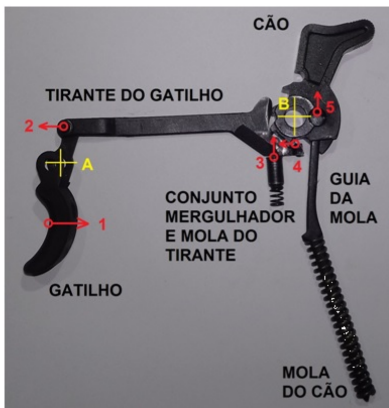
Figura 1 – Diagrama de peças com vetores de força
