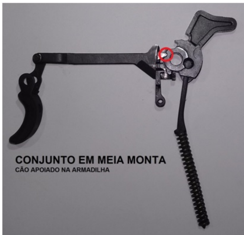
Figura 5 – Posicionamento do conjunto no momento do contato do cão com o percussor
